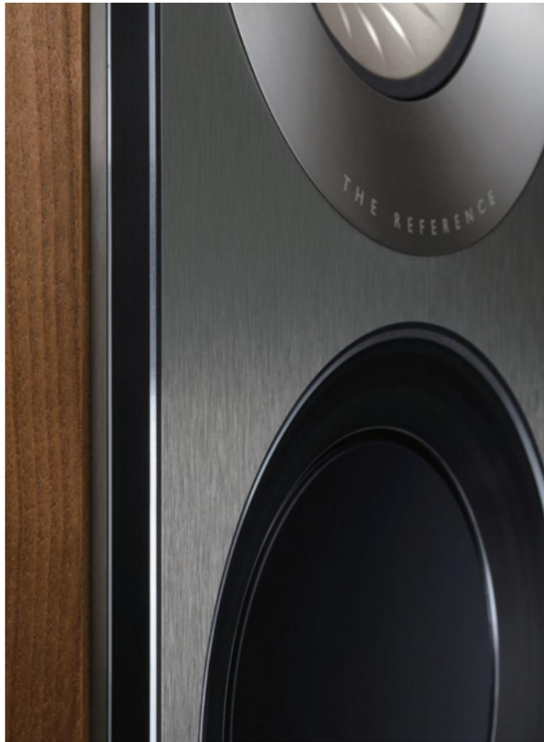
The Reference のフロントバッフルは、共振を完全に排除した理想の構造で、ドライバーの性能を 100% 引き出します。2 枚の厚いアルミにレジンをはさみ高温、高圧で造られたもので、キャビネット全体にも高硬度を形成させます。バッフル自体もダンピング機能が有り共振を排除します。さらに、フロントバッフルは多くのボルトでリアバッフルと結合され張力でもテンションが与えられ共振はほぼない構造となっております。
