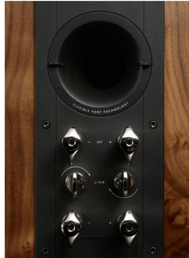
フレキシブルポートは LS50 で開発された技術で、低域のエクステンションと中・高域への影響を無くした独創的なポート技術です。The Reference ではポートの形状は流体力学を使いポート内や出口に発生する空気の渦を解消しています。さらに内部のソフトなフレキシブルポートは宙域へのポートの影響を無くしています。その違いは特に 30-80Hz の領域で顕著です。
