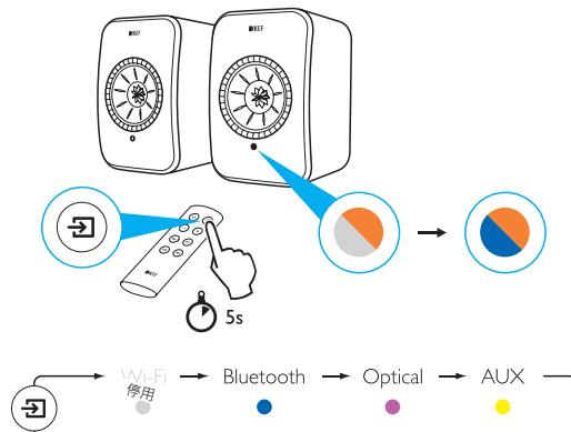
如使用Wi-Fi連接來恢復使用LSX，請將揚聲器重設為 Setup Mode (設定模式)。請參閱 "重設為原廠設定" 一節的說明，重設揚聲器為 Setup Mode (設定模式)。
