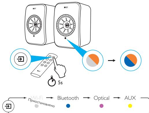
Для того чтобы вернуть систему LSX в режим работы с подключением Wi-Fi, переведите динамик в режим настройки. Подробную информацию о сбросе настроек см. в разделе «[Сброс до заводских настроек](#)».
