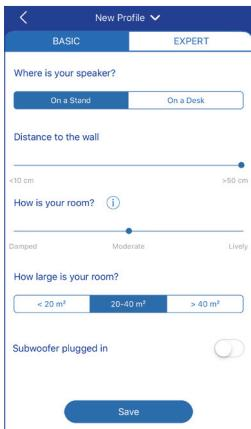
Режим Basic («Базовый») позволяет настроить параметры эквалайзера в соответствии с вашей областью прослушивания. Возможные настройки указаны ниже.
